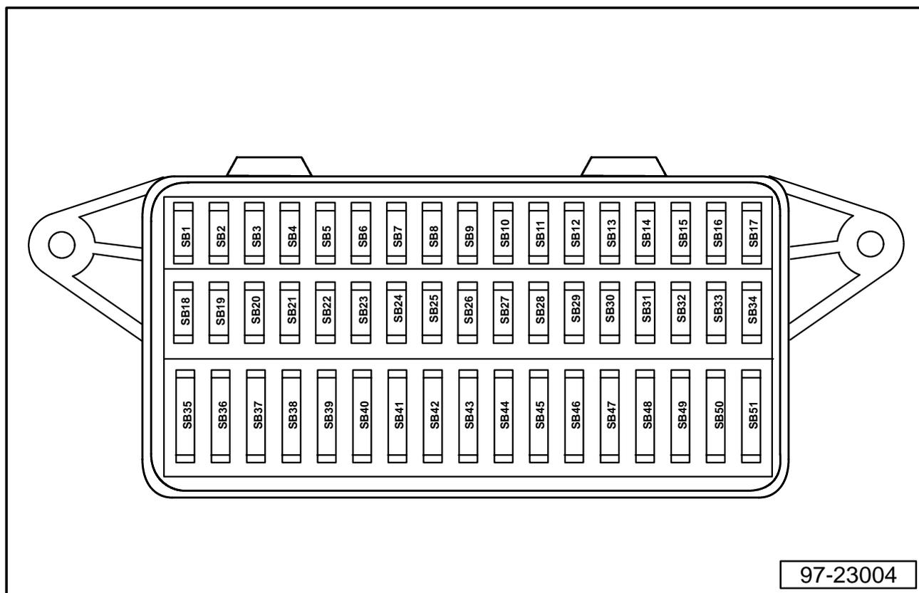
Les raccords électriques des fusibles sont repris dans les schémas de parcours du courant correspondants. Pour la protection par fusibles des équipements optionnels non présentés, consulter les schémas électriques correspondants.
